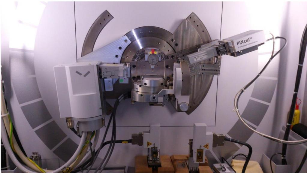
Messeinrichtung eines Röntgendiffraktometers
