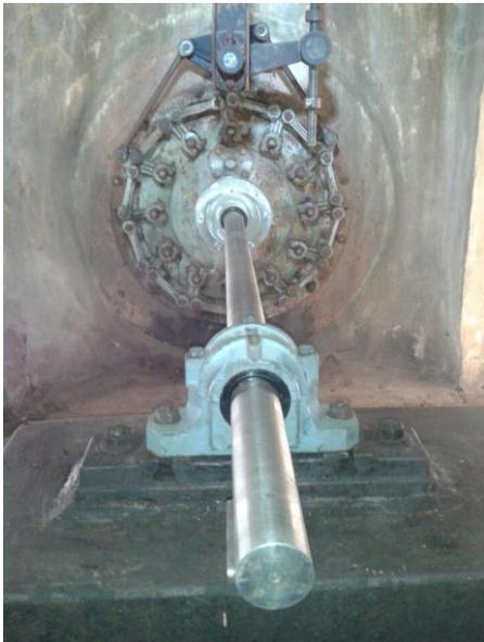
Auf dem Bild ist der im Haus liegende Teil der Wasserkraftanlage, im fertiggestellten Zustand, zu sehen. Im Detail sieht man die Mechanik der Wasserregulierung, sowie die Antriebswelle und deren Lagerung.
